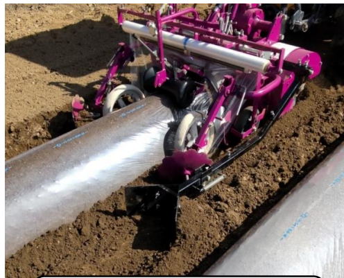
溝浚板ASSY3型 全長が短くコンパクトです。
