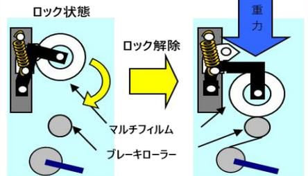
ササオカ独自のシステムにより、マルチフィルムの残量に合わせ、マルチフィルム自体の重さで適度にブレーキを掛けるので、マルチを綺麗に張るためのブレーキ調節が最初の1度だけしか必要ありません。
