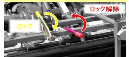
システムのロック・解除は赤・黄のレバーでワンタッチで行えますので、作業時からマルチフィルムの交換時まで、作業が簡単に行えます。
