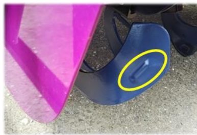
黄色で囲った部分がセンサーリブです。 リブまで消耗が到達したら交換時期です。
