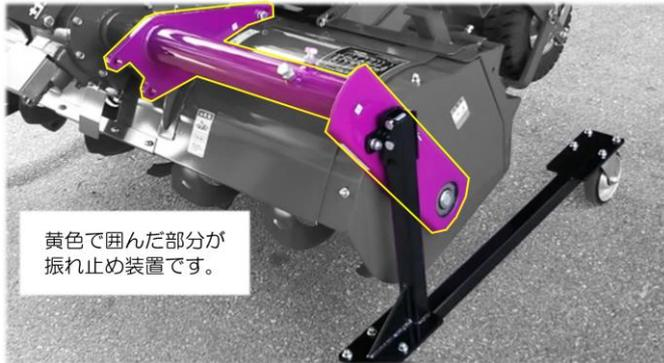
黄色で囲んだ部分が振れ止め装置です。
