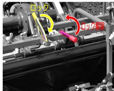
システムのロック・解除は赤・黄のレバーでワンタッチで行えますので、作業時からマルチフィルムの交換時まで、作業が簡単に行えます。
