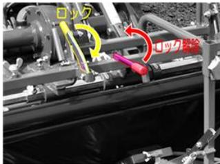
システムのロック・解除は赤・黄のレバーでワンタッチで行えますので、作業時からマルチフィルムの交換時まで、作業が簡単に行えます。
