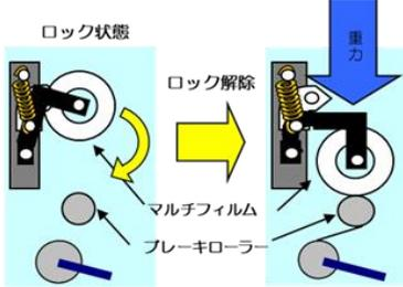
ササオカ独自のシステムにより、マルチフィルムの残量に合わせ、マルチフィルム自体の重さで適度にブレーキを掛けるので、マルチを綺麗に張るためのブレーキ調節が最初の1度だけしか必要ありません。
